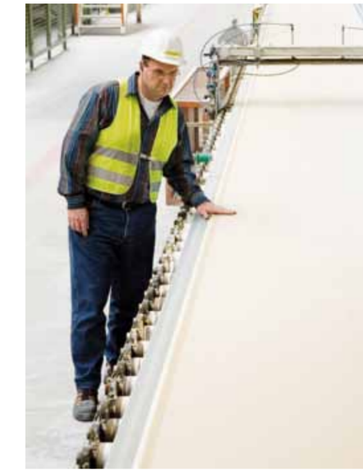
Auf dem Produktionsband werden die beiden Rohmaterialien Gips und Karton zu einer stabilen Rigips-Platte.
